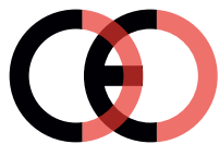
Marcatura CE contraffatta (troppo vicino)
